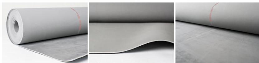
Elektrisch isolierende Matte zertifiziert nach IEC 61111:2009 in Klasse O, mit Arbeitsspannung 1.000 V, mit Prüfspannung 5.000 V und mit Stehspannung 10.000 V, mit permanent vulkanisiertem Markierungsband. Vulkanisiertes Elastomer feingerieft in grauer Farbe mit beidseitigem Abdrück, 2,5 mm dick (+/- 0,3mm). Flächengewicht von 3,8 kg/m<sup>2</sup>.
